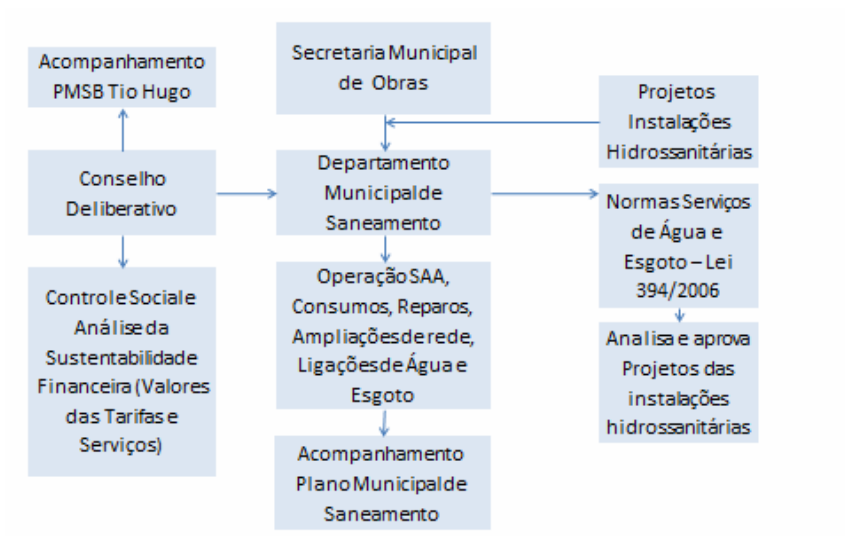
Figura 3.2 – Esquema explicativo da regulação dos procedimentos relacionados à prestação dos serviços de abastecimento de água e aprovação de projetos hidrossanitários.
