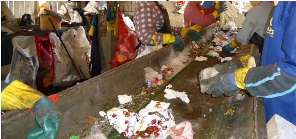
Figura 5-5 - Esteira de triagem dos resíduos.
